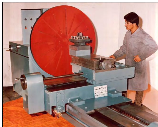
طراحی و ساخت اولین سنگین تراش برای ماشین کاری قطعات سنگین تا قطر 1500mm و وزن 2ton (سال ۱۳۶۵)
